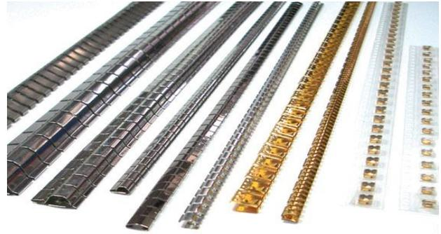
ベリリウム銅板の反発性を活かした爪状の細長い、または、小片のガasketである。反発力の劣化が他のガasketに比べると小さいので信頼性が高い。形状が豊富にある。嵌め込み方式と両面粘着テープで貼り付ける方式の製品がある。圧迫のストレスがかかる方向を考慮して、取り付け方向に注意を要する製品もある。
