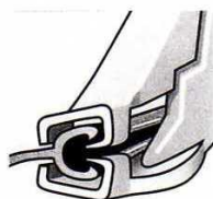
図12 ビニル・ジッパーの形状と プライヤーで装着された様子
